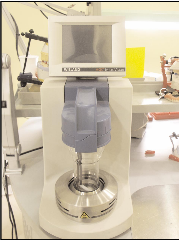
Εικόνα 4: Η δεξαμενή επίστρωσης, αποτελούμενη από δοχείο και δοκό ανάδευσης.
